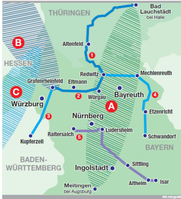
Von den HGÜ-Gleichstrompassagen (A bis C) sind die genauen Trassenverläufe noch nicht bekannt. Aufgerüstet und ertüchtigt werden die Hochspannungsleitungen von Altenfeld nach Redwitz (1), von dort in Richtung Oberpfalz (4) und nach Grafenrheinfeld (2) mit Verlängerung nach Kupferzell (3) sowie womöglich auch zwischen Raitersaich und Ludersheim (5).
